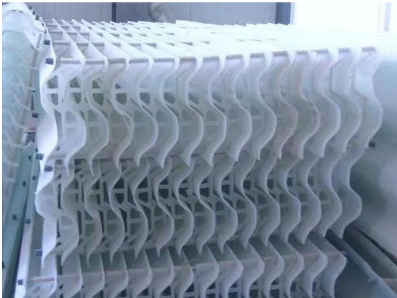
**除雾箱：**除雾器作为一款烟气脱硫的工业废气处理设备，目前衡量除雾器性能参数
